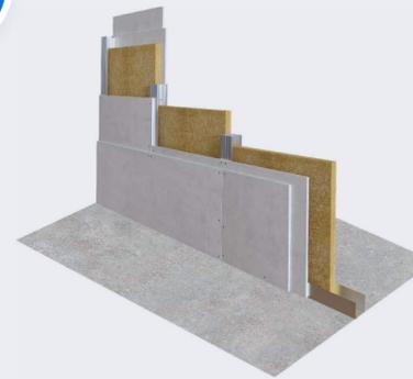
Шумоизоляция в гипсокартонных перегородках
